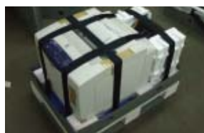
(マジックバンド固定/機種に関係なく対応&リターナブル)
