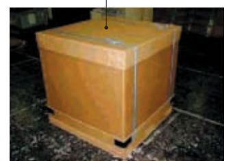
⑥ トップカバーをセットしてPPバンドで固定
